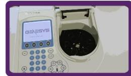
**Aufgabe:** Erstellen Sie für das Coenzym  $\text{NAD}^+$  und seine reduzierte Form  $\text{NADH}$  jeweils ein Absorptionsspektrum im Wellenlängenbereich zwischen 240 – 380 nm mit Hilfe des Photometers.
